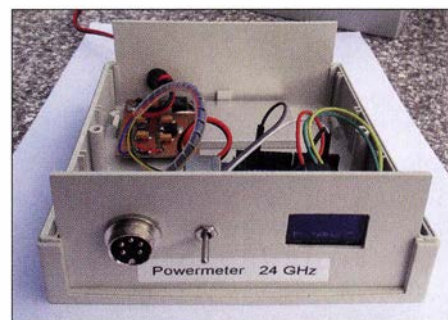
Den 1. Platz im Selbstbauwettbewerb belegte DJ8ES mit diesem Leistungsmesser für 24 GHz [3], der auf einem über die Buchse anzuschließenden Detektorkopf aus dem Surplus basiert.
