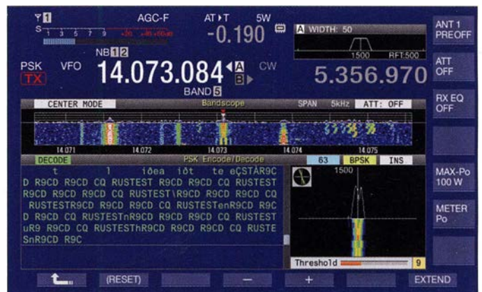
Bild 4: Bandskop und Wasserfall gehen nicht unbedingt verloren, wenn der untere Displayteil anderweitig genutzt wird; sehr nützlich beispielsweise bei der Nutzung des PSK-Decoders.
