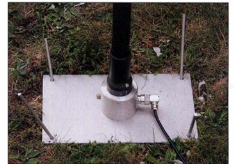
Bild 6: Der nachgebaute Antennenfuß mit dem Original-Mastadapter für einen militärischen Antennenkoppler
