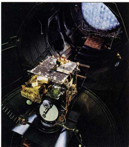
Bild 3: Satellit Artemis in der Testkammer des Large Space Simulator im ESTEC
