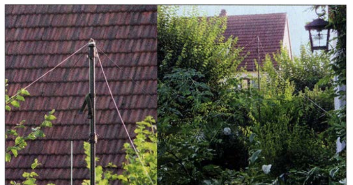
Bild 5: Antennenkopf (links) und Gesamtansicht der AS2599 als „Tarnantenne“ im Garten (rechts)
