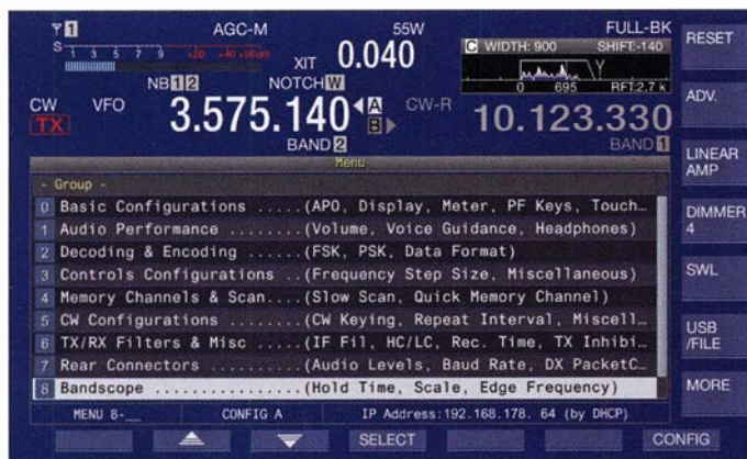
Bild 3: Die Punkte des Haupt-Menüsystems führen auf zehn Untermenüs. Die Softkeys rechts ändern beim Menüaufruf ihre Bezeichnungen und bieten Zugang zu weiteren Einstellungen.
