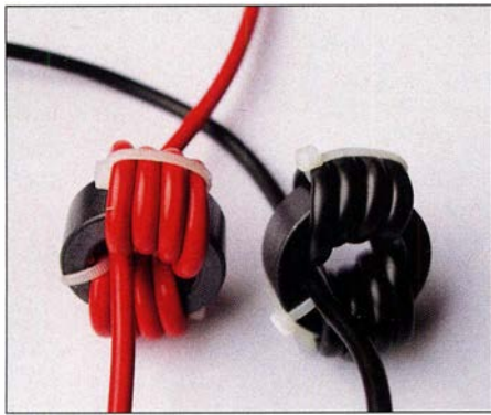
Bild 3: Für die beiden Drosseln auf der Sekundärseite des Schaltnetzteils hat sich das hier gut erkennbare Wickelschema bewährt.
