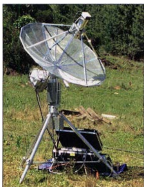
Er sieht schon recht professionell aus, HB9CRQs Spiegel für die SHF-Bänder. Fotos: PA3CMC
